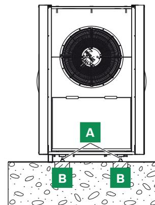
**A** Fijación con 4 tornillos
