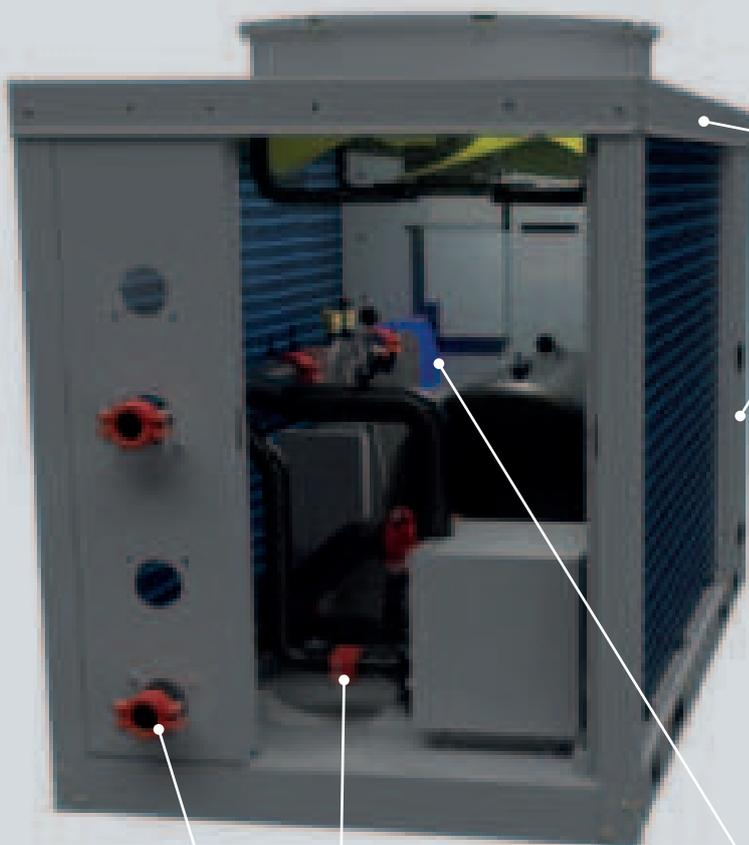
Estructura, base y paneles, fabricados íntegramente en chapa de acero de espesor 12/10, galvanizado en caliente y pintado con polvo de poliéster RAL 9001 que garantiza excelentes características mecánicas y alta resistencia a la corrosión en el tiempo. Los paneles se pueden quitar fácilmente para acceder completamente a los componentes internos.
