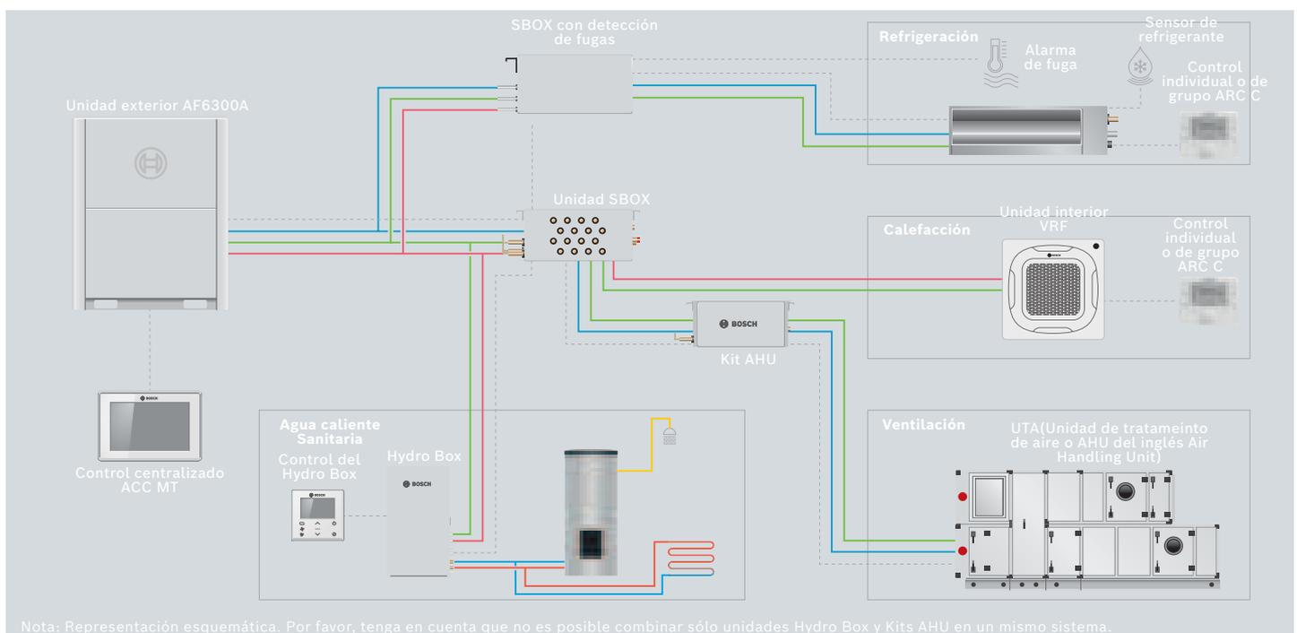
La gama Air Flux 6300A C permite la instalación en cascada de unidades exteriores consiguiendo sistemas de mayor potencia. La combinación de hasta 3 unidades exteriores le permitirá conseguir sistemas de hasta 150kW.
