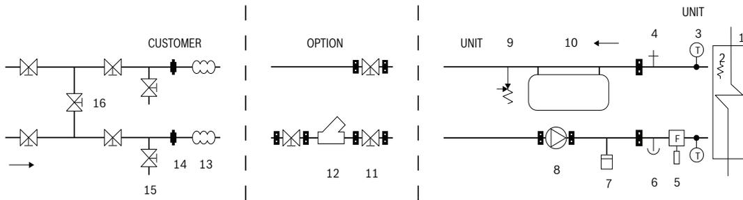
**Bomba de calor con bomba de primario y depósito de inercia integrados**
