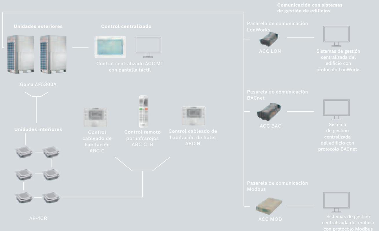
Representación esquemática del conexionado, no incluye todos los elementos necesarios.
